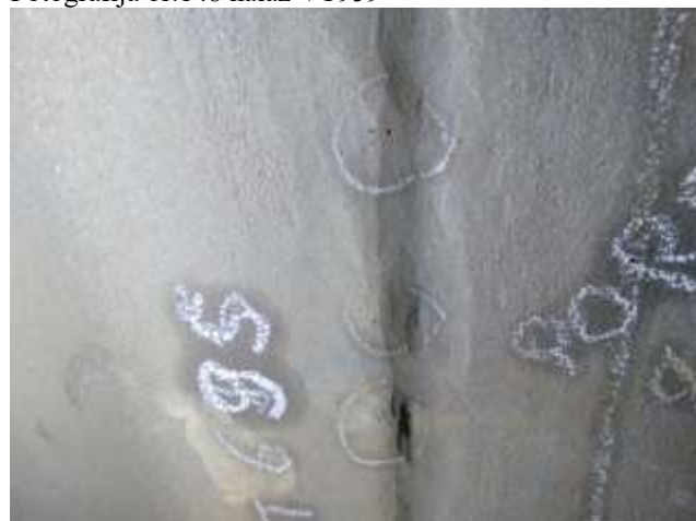
Fotografija br.150 nalaz VT -2017 površinske pore
