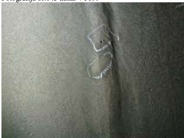
Fotografija br.147 nalaz VT -2017 površinske pore
