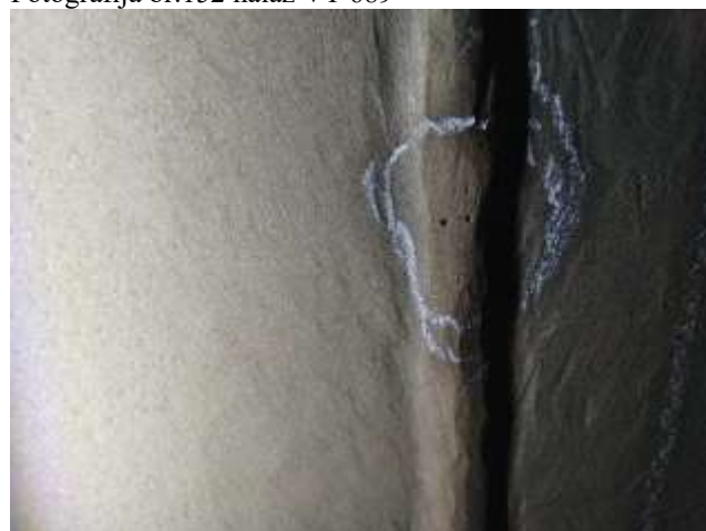
Fotografija br.154 nalaz VT -2017 površinske pore
