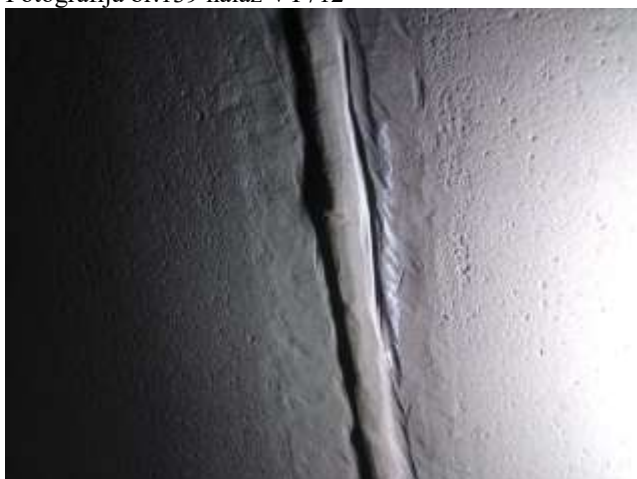
Fotografija br.141 nalaz VT – obrušen ZUT po celoj dužini
