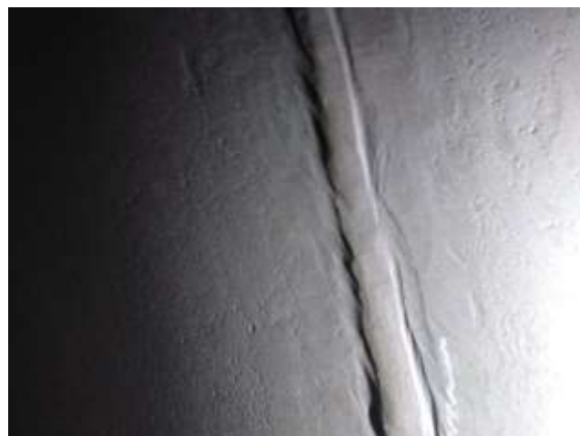
Fotografija br.140 nalaz VT – obrušen ZUT po celoj dužini
